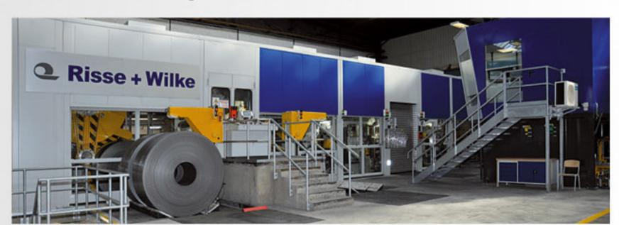
Risse + Wilke verfügt damit über eines der modernsten Walzgerüste Europas, das in der Betriebsart der Reversiertechnik als Quartogerüst betrieben wird. Bis zu einer Walzbreite von 750 mm werden enorme Walzdrücke bei Walzgeschwindigkeiten bis max. 600 m/Min. aufgebracht, so dass die Banddicke des eingesetzten Warmbandes auch bei hochkomplexen Werkstoffen sehr maßhaltig und mit hoher Produktivität reduziert werden kann.
