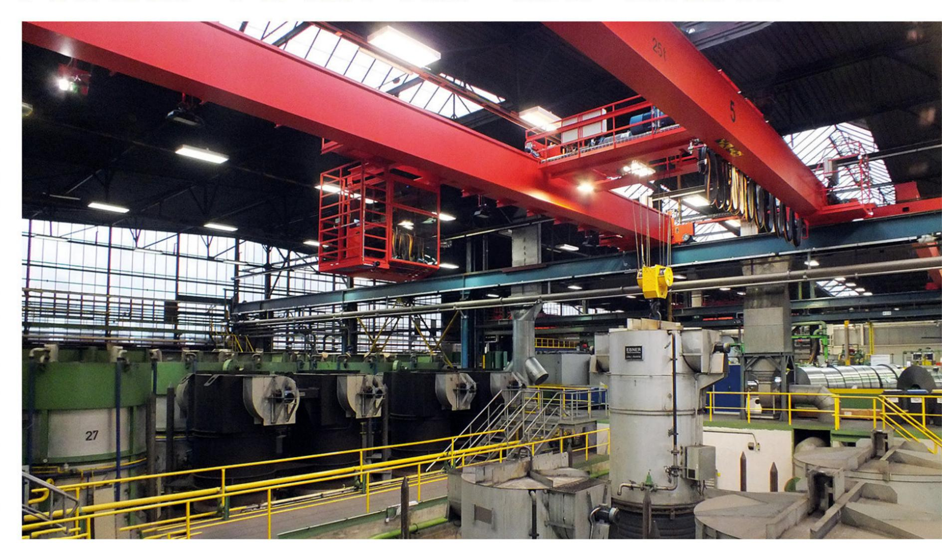
Im Dezember 2018 wurde in der Glühhalle, als Ersatz für einen vorhandenen, in die Jahre gekommenen Kran, ein neuer Kran montiert. Der neue Kran hat eine Tragkraft von 25 Tonnen und eine Spannweite von knapp 26,5 Metern.
